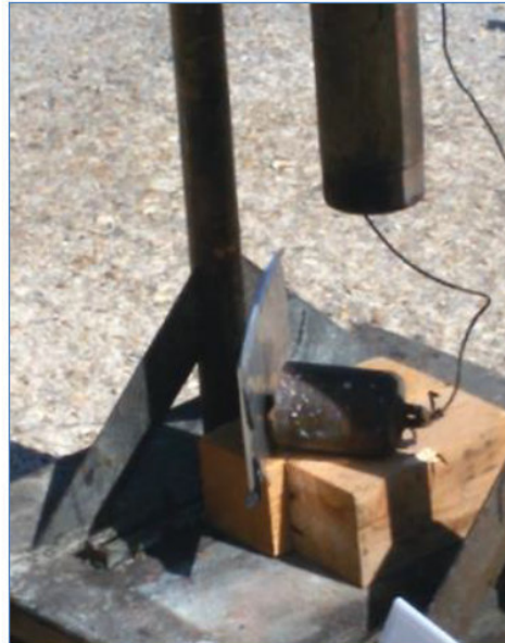
Figura 38. Prova di perforazione con un maglio mediante caduta dall'alto (Urto)
