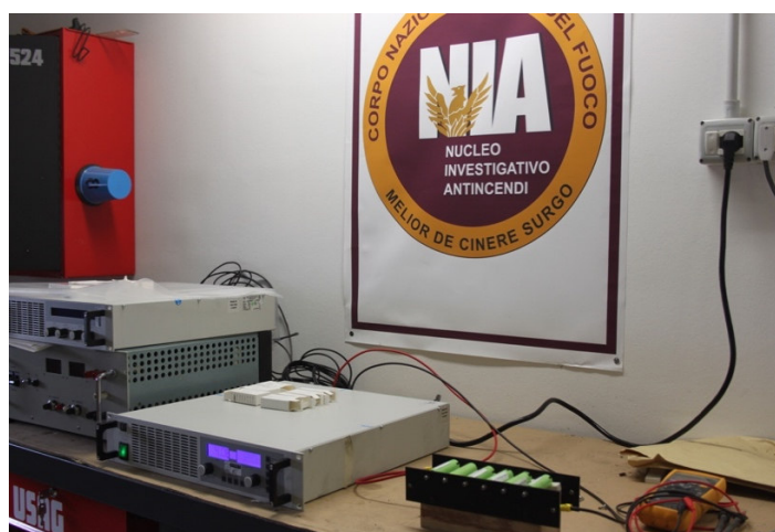
Fig. 5 – Celle durante la fase di carica.
