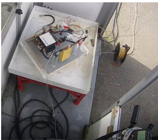
Figura 26. Setup di prova di cortocircuito con cella Tundersky TS LFP 60 Ah [44]
