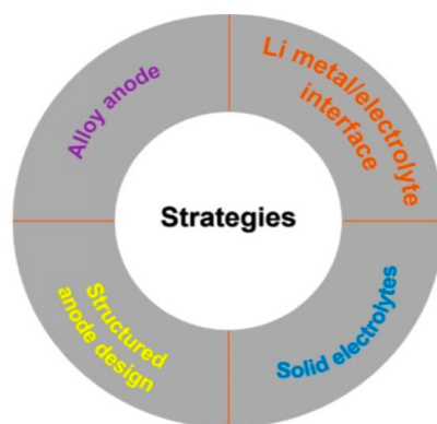
Fig 46 – Strategie proposte per superare la crescita delle dendriti [23].
