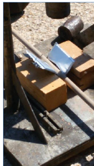
Figura 39. Prova di bending con sbarra cilindrica
