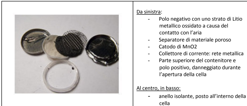
Figura 5. Pila al Litio CR2032: schema di funzionamento e vista interna. Fonte [8]
