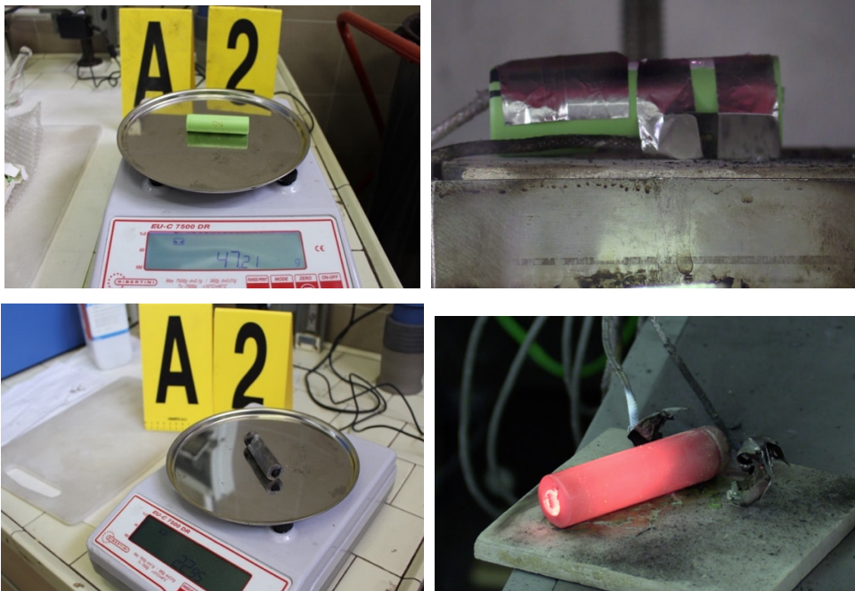
Fig. 6 – Cella NCR18650 Panasonic prima (in alto) e dopo (in basso) le prove al calorimetro al cono.
