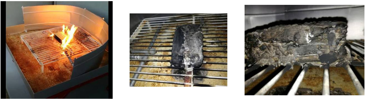
Figura 28. Cella Tundersky TS LFP 60 Ah . Prova di esposizione a fiamma, fino a combustione completa [44]
