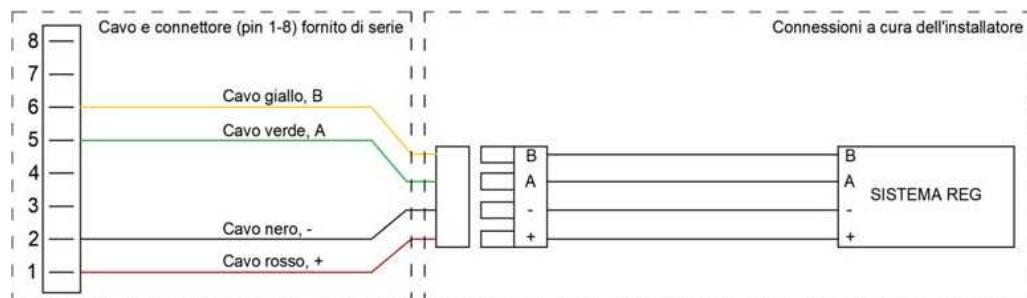
3. Giuntare i cavi del connettore fornito in dotazione con quelli del sistema e successivamente reinserire nel foro la giunzione.
