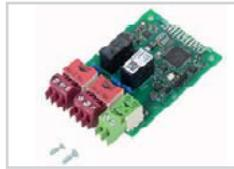
Scheda per remotare lo status caldaia attraverso contatti puliti (stand-by, funzionamento ACS o riscaldamento, allarme, uscita 0-10 V). Ordinare anche SCU-box cod. 22-1780.
