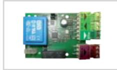
Per comandare la caldaia tramite un segnale analogico esterno 0...10 V. Ordinare anche SCU-box cod. 22-1780.
