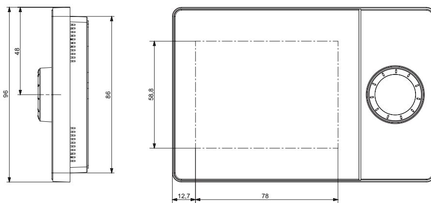
Collegare il comando remoto al controllore dell'unità utilizzando cavo a 3 fili di sezione minima 0,5 mm<sup>2</sup> e lunghezza massima 200 metri.
