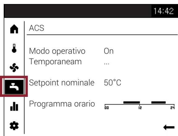
Impostando il modo operativo su "On" la pompa di calore mantiene la temperatura dell'accumulo vicina al set point nominale attivando una valvola a tre vie (**Q3**) per deviare il flusso della pompa di calore dai circuiti di riscaldamento/raffreddamento verso l'accumulo dell'acqua calda sanitaria.
